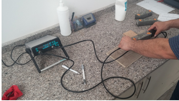
Şekil 7. Numunelerin ultrases geçiş hız değerlerinin belirlenmesi
