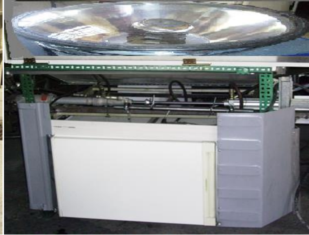
Şekil 12. Silindir piston ile iş elde edilmesi. Prototip.
