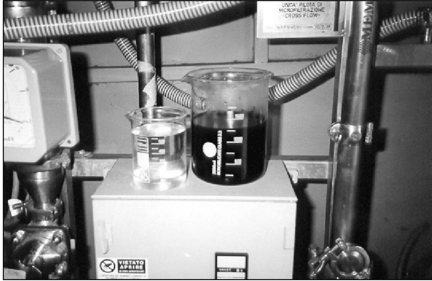
Şekil 2. Nanofiltrasyon prosesinden önce (sağ beher – besleme) ve sonra (sol beher - permeat) örneklerin fotoğrafları [8]
