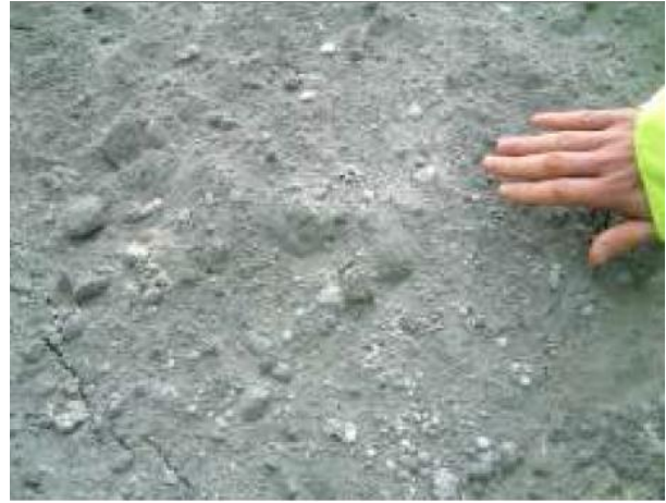
Şekil 2. Düşük Al sahip beyaz cüruf
