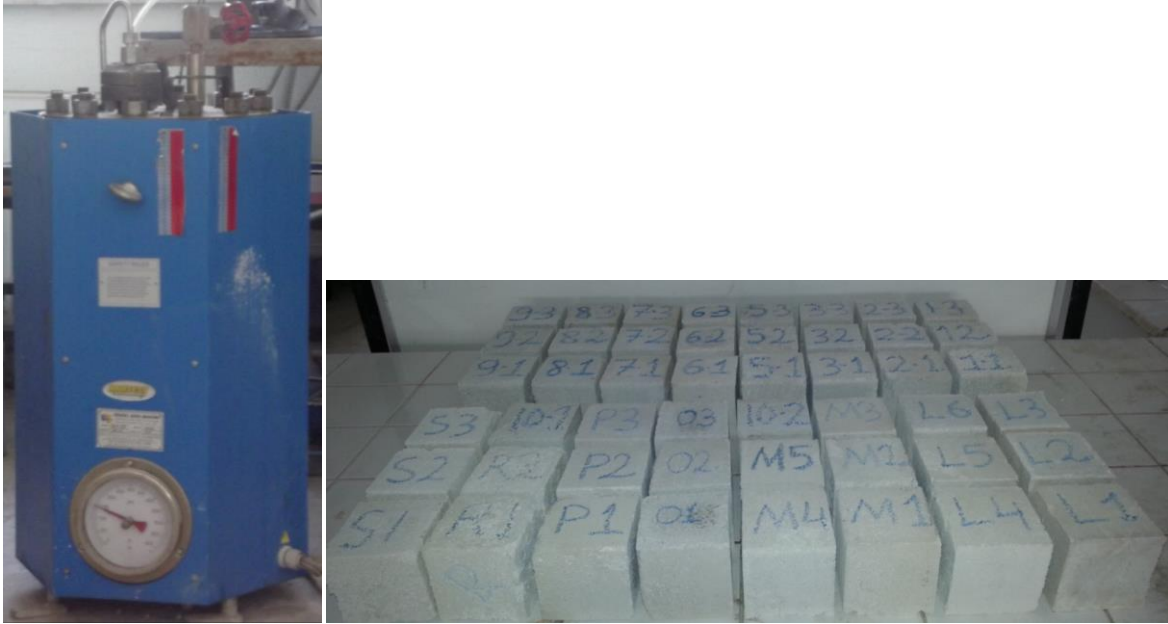
Şekil 5. Çalışmada kullanılan otoklav cihazı ve üretilen gazbeton örnekler.
