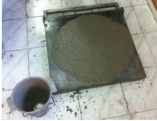
Şekil 1. Yayılma ve T_{50} süresi ölçümü deneyinin yapılışı
